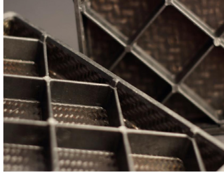
SobreInyección de estructura termoplástica sobre laminados de fibra de carbono y vidrio de base termoplástica de iGestek. Image courtesy of Igestek.
