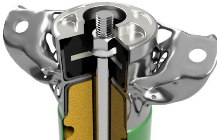
Diseño final del nuevo soporte amortiguador. Imagen cortesía de Igestek.
